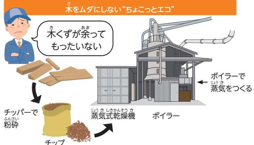
木材を乾燥させるために使う燃料には、工場で出た木くずを使用しています。木材をムダにすることなく使い切れます。
